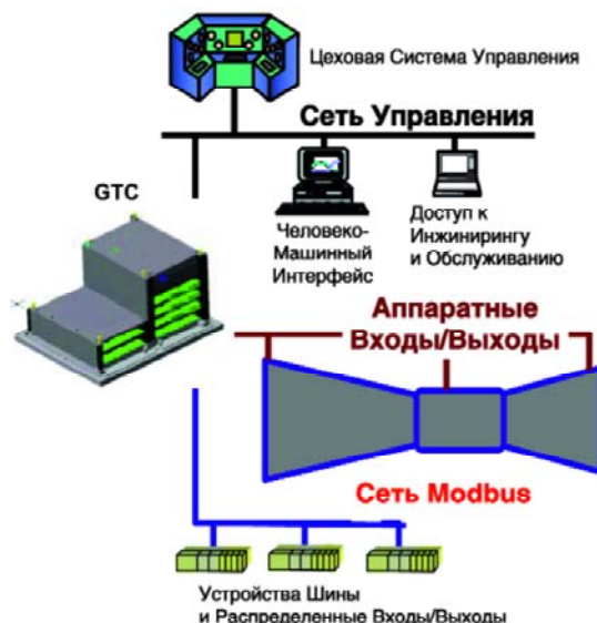
Типовая Конфигурация GTC100/200 - Стратегия Сетевого Управления
